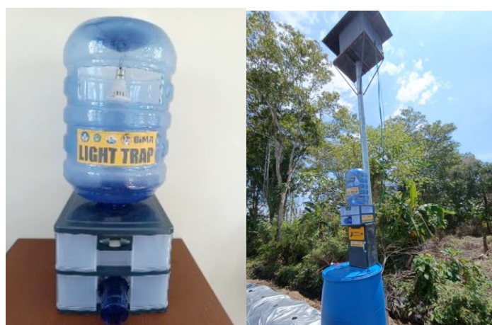
Gambar 1. a. penampakan desain light trap ; b. penampakan light trap yang telah terpasang di lapangan
