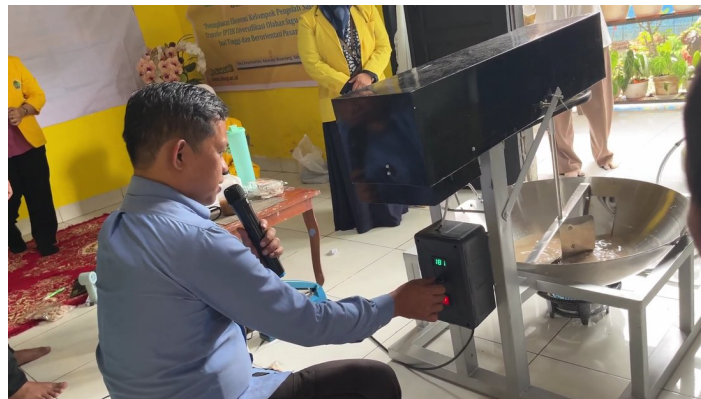
Gambar 2. Demonstrasi produksi gula sagu cair menggunakan mesin pembuat gula sagu
