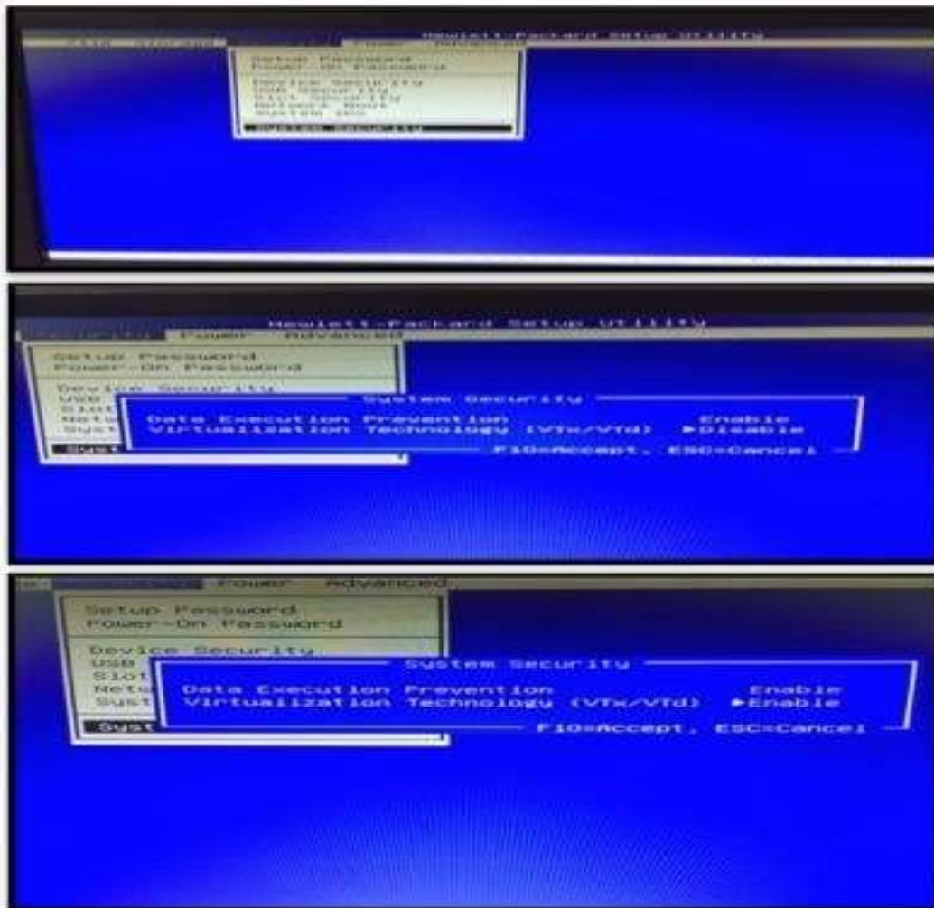
Gambar 30. Langkah-Langkah Mengaktifkan Virtualization Technology (VTx/VTd) di BIOS
