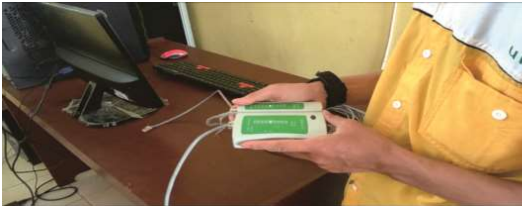
Gambar 7. Test Koneksi Kabel dengan Menggunakan LAN Tester
