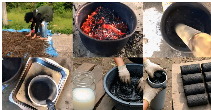
Gambar 1. Alur Pembuatan Briket Nilam
